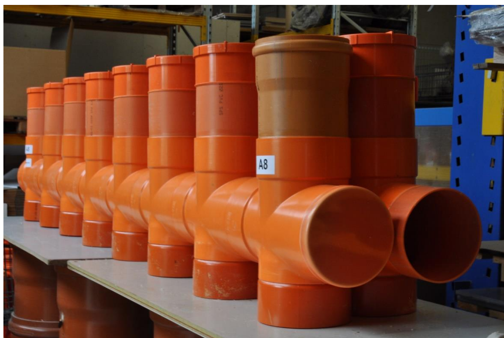
Collettore pavimento biocelle.
